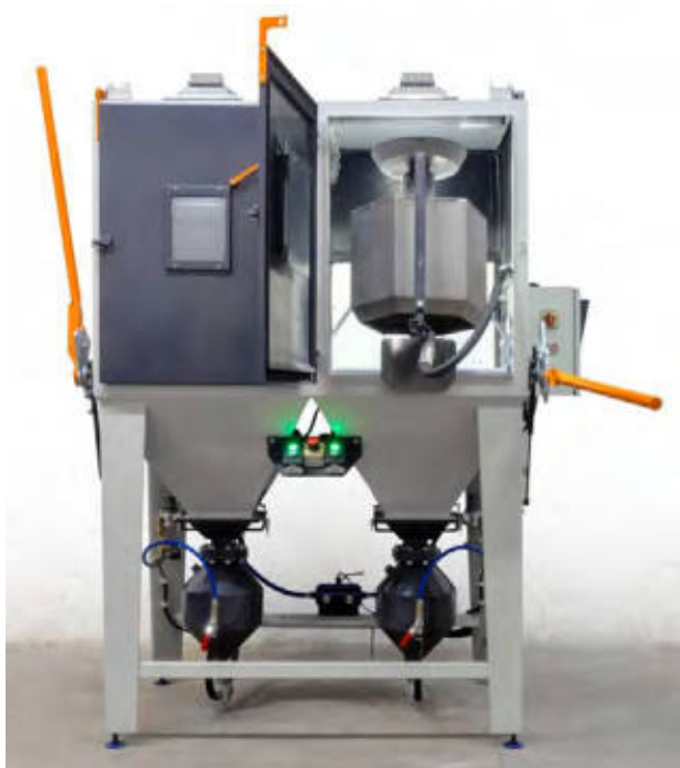
Dvojbubnový tryskač s ručním vyklápěním pákou
