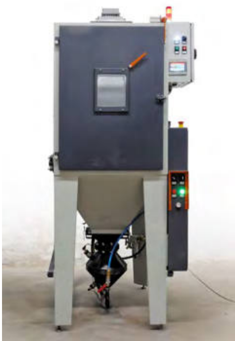
Bubnový tryskač s pneumatickým vyklápěním a dotykovým panelem řízení
