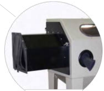
Protahovací otvory ve dveřích pro tryskání tyčového materiálu
