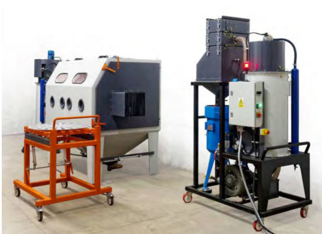
TTB 200 s vnější dopravou abraziva s tlakovou nádobou 70 litrů. Kabina je vybavena protahovacími otvory, vyjížděcí točnou s vozíkem
